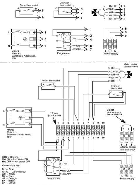
Fig. 6.20 - Not permanent live Y-plan
